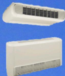
Внутри фанкойла имеется теплообменник, вентилятор и схема управления. В качестве теплоносителя фанкойл использует воду, а не фреон. Как и во внутреннем блоке кондиционера, теплового насоса воздух-воздух, фанкойлы могут быть настенного, напольного, потолочного, кассетного, канального и других типов.
