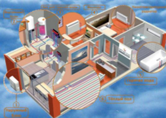
**Бак бытовой горячей воды.** Что касается бытовой горячей воды, система так же практична и в этом отношении. Уникальная разработка и особый план расположения компонентов максимально увеличивают эффективность энергоиспользования. Вода внутри бака нагревается тепловой энергией наружного воздуха благодаря теплообменнику, встроенному в бак и подключенному к теплому насосу. В баке воды установлен элемент электрообогрева, который может дополнительно нагревать воду.
