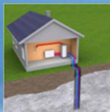
Скважный тип «земного источника» - когда одна или несколько скважин бурится в грунте, куда, собственно, опускается теплообменный контур, заполненный этиленгликолем (антифриз). Преимуществом этого метода является то, что он оказывает минимальное воздействие на поверхностный слой грунта.
