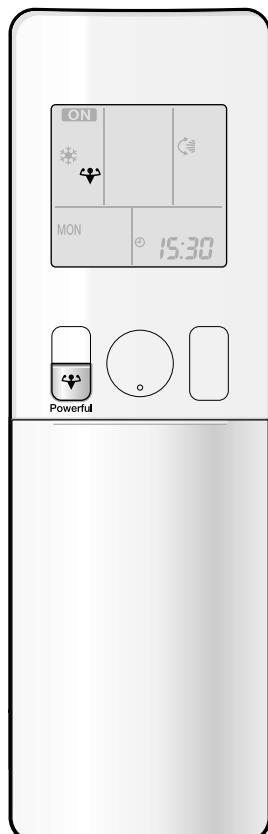
В режиме ПОВЫШЕННОЙ МОЩНОСТИ эффект охлаждения (обогрева) быстро доводится до максимума в любом режиме работы. Можно обеспечить максимальную производительность.
