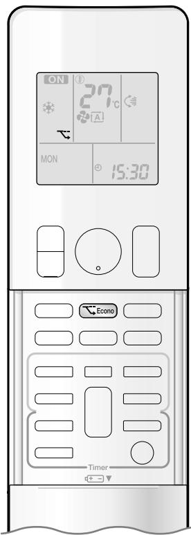
Работа в режиме ЭКОНОМ представляет собой функцию, обеспечивающую эффективную работу при ограничении максимальной потребляемой мощности. Этот режим полезен в случае работы кондиционера совместно с другими отопительными приборами, чтобы не допустить срабатывания автоматического выключателя.
