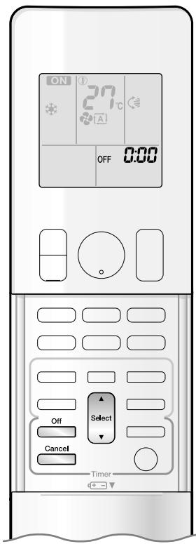
Функции таймера используются для автоматического включения или выключения кондиционера на ночь или в утренние часы. Можно пользоваться также комбинацией операций ТАЙМЕР ВЫКЛ и ТАЙМЕР ВКЛ.
