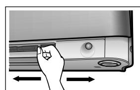
Если их направить на стену, стена будет перекрывать воздушный поток, тем самым понижая эффект охлаждения (или обогрева).
